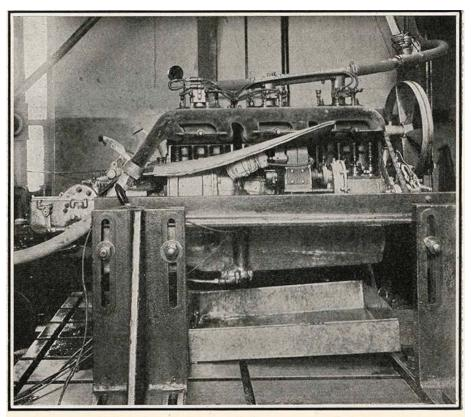
PACKARD 6-38 MOTOR ON THE TESTING STAND IN THE A. C. A. LABORATORY.
